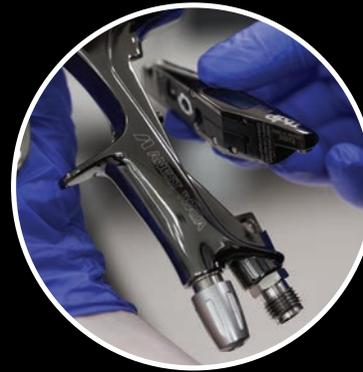
Klammer verwenden, einrasten lassen und Lackierpistole reinigen
